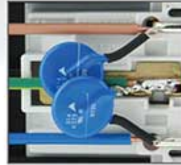
ป้องกันฟ้าผ่า ไฟกระชอก ไฟกระชาก ในทุกโหมด ( All modes Protection : L - N , L - G , N - G ) ด้วย MOV ยี่ห้อ TDK ( เดิมยี่ห้อ SIEMENS ) คุณภาพมาตรฐานสากล
